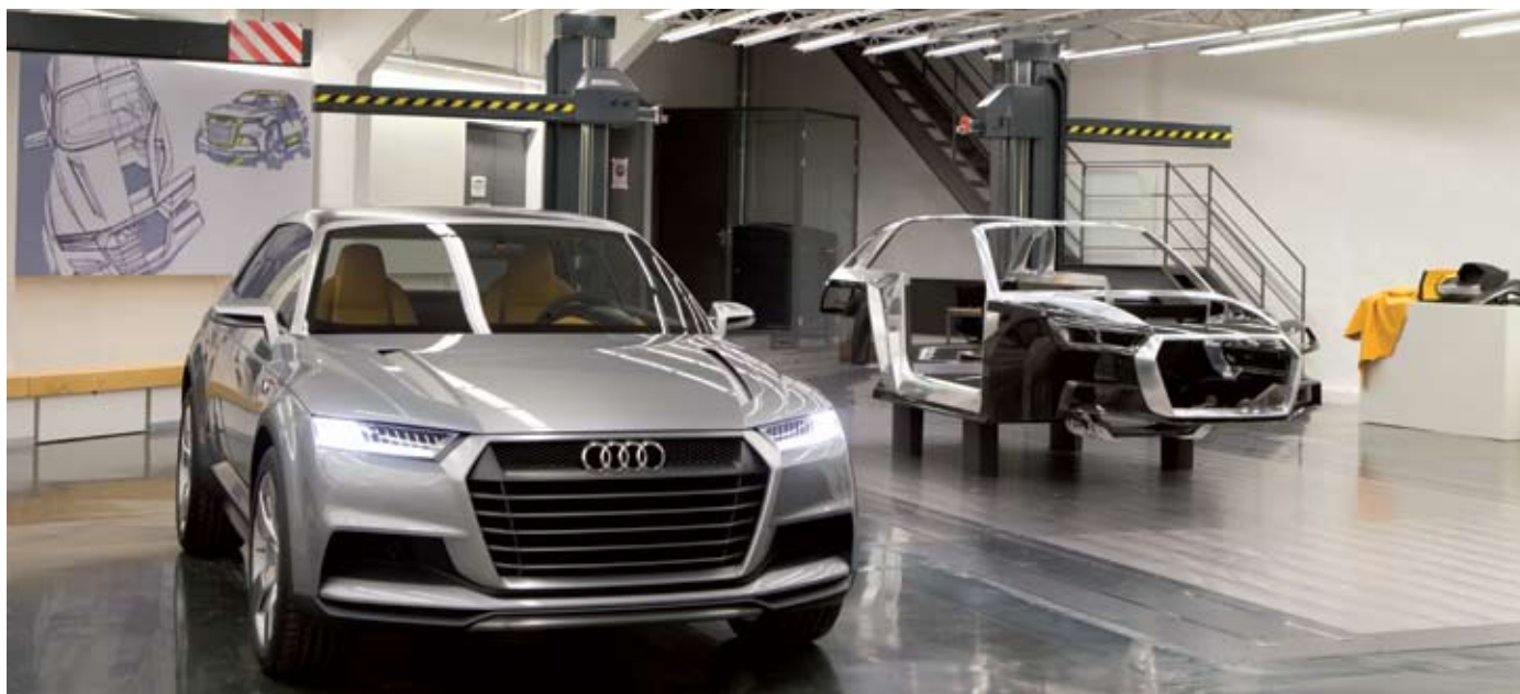
Audi shpalos teknologjinë: Struktura e karrocisë në formën e një strukture rrjetë duket qartë e integruar në dizajnin e kupës crosslane. Audi reveals its technology: The body structure in the form of a Space Frame is clearly integrated into the design of the crosslane coupé.
